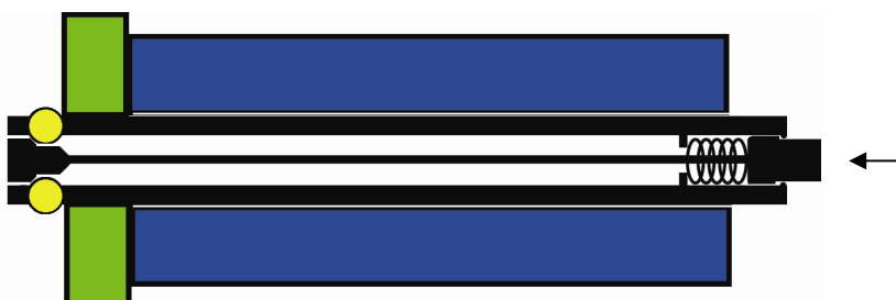
Bild 2.6: Standard quick-release. Hjulnav (blå), infästning i ramen (grön) och kulor (gul).
