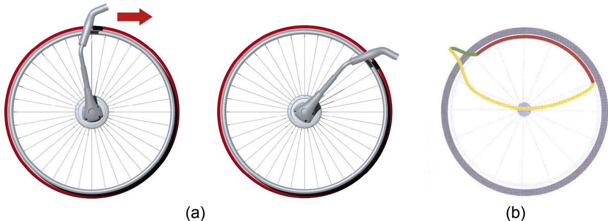
Bild 1.1: Principen för hävstångsdrift (a). Vanlig drivningsdrift (b). Grön är anloppsfasen där handen sätts mot drivringen, röd är drivfasen och gul pendelfasen då handen går tillbaka till ursprungsläget.
